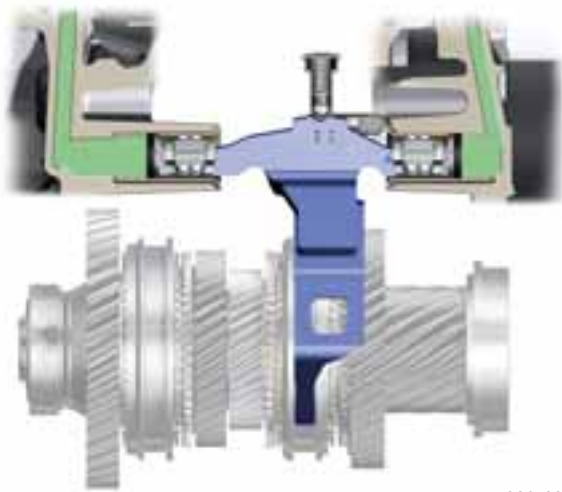
Schaltgabel in Neutralstellung drucklos
